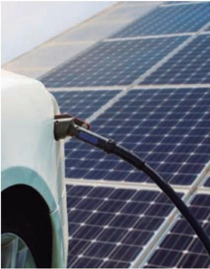
» La unidad posee dos vías de recarga de batería: un sistema de consumo doméstico para conectarlo a 220 volts de potencia en cualquier domicilio, y un techo solar que favorece cierta recuperación de energía.
